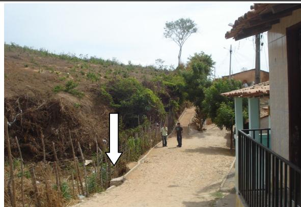
**Foto 06** – Observa-se a esquerda da foto o local onde será implantada a EEE-03. No sopé deste morrote passa um pequeno curso d'água (bueiro indicado pela seta), estando a EEE-03 posicionada na sua faixa de proteção e provavelmente sujeita a alagamentos.
