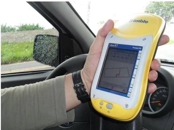
**FOTO 09** – Equipamento GPS utilizado na localização das áreas dos empreendimentos.
