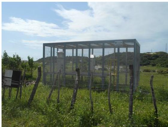
**Foto 6.54:** Estação de monitoramento de materiais particulados e de níveis de pressão sonora implantada as margens da Lagoa do Pecém. Fonte: Engesoft, 2016.
