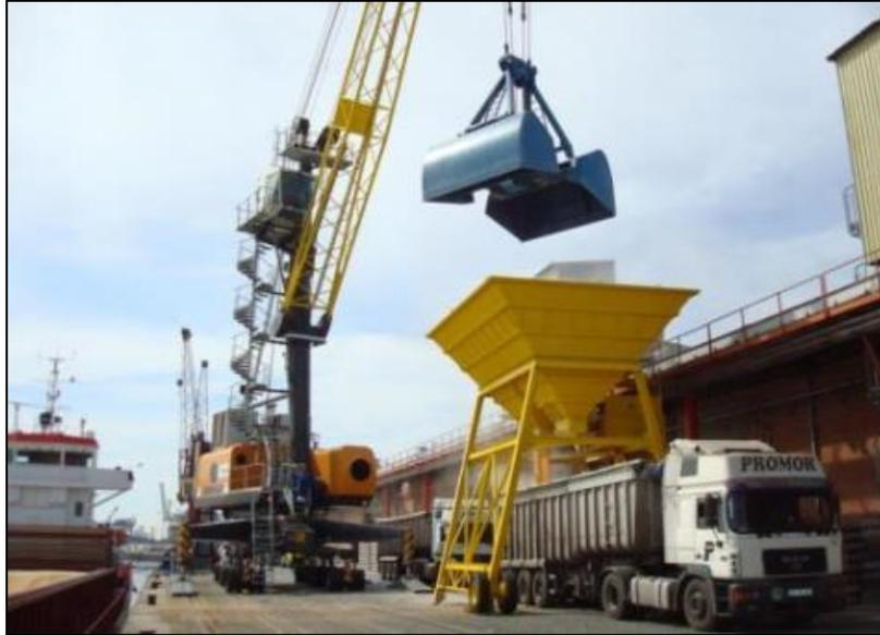
**Foto 2.12:** Carregamento de caminhões com o uso de guindaste MHC e moega de carregamento (modelo).
