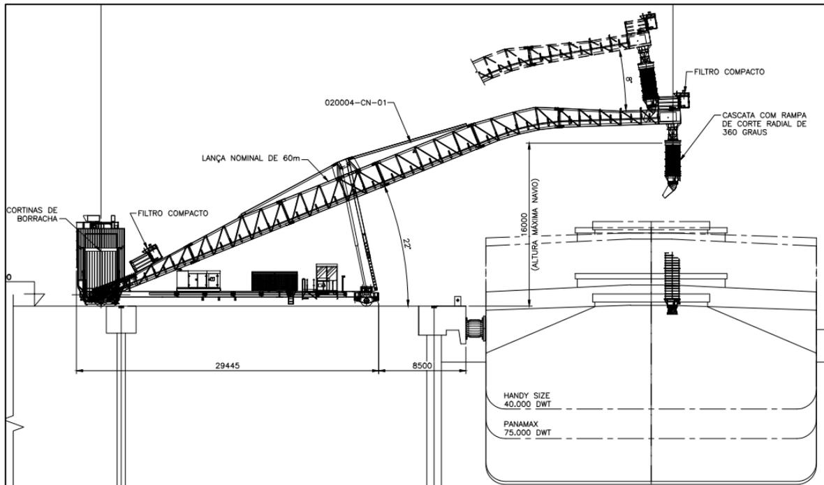
Figura 2.9 - Carregador de Navios Móvel – Carregamento Simultâneo de 2 Caminhões
