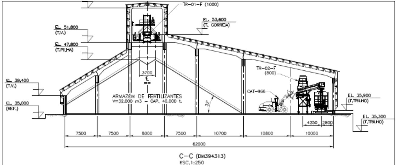
Figura 2.13: Carregamento de Vagões e Caminhões com Fertilizantes
