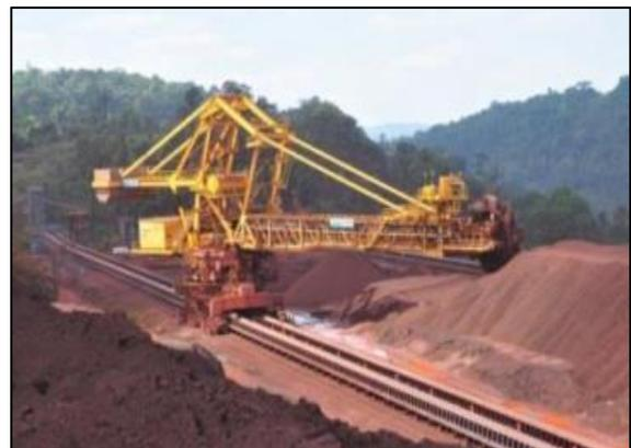
**Foto 2.4:** Recuperadora de minério de ferro do tipo lança e roda de caçamba (modelo)
