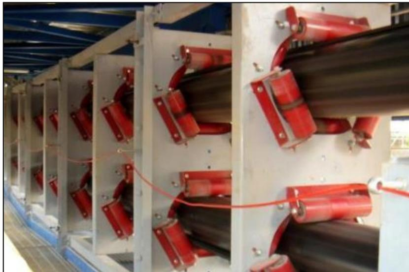
**Foto 2.10:** Modelo de Transportador Tubular (modelo).
