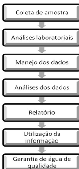
Figura 11.1 – Fluxograma das etapas do monitoramento das águas superficiais e subterrâneas
