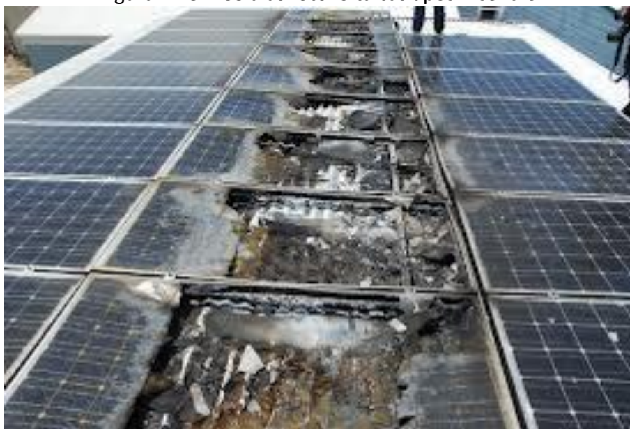
Figura 11.3 – Células fotovoltaicas após incêndio.
