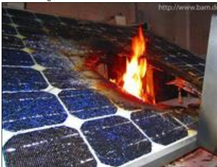
Figura 11.2 – Célula fotovoltaica incendiada.
