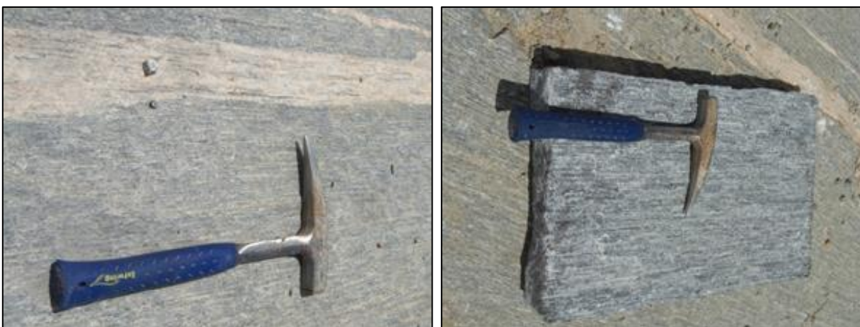
Figura 7.12 – Detalhe do material rochoso explorado na Pedreira de Francisco Amary de Lima, consistindo num gnaíse leucocrático, provavelmente da Unidade Mombaça.
