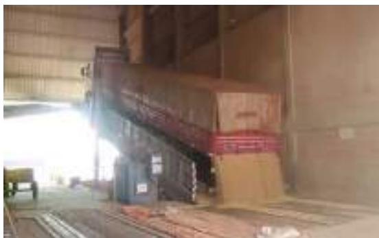
Foto 2.5: Descarga de grãos agrícolas em tombador de caminhão (modelo).
