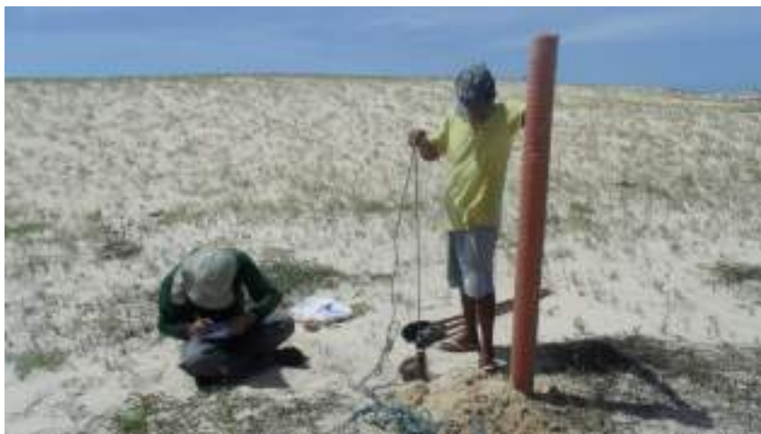
Foto 6.10: Coleta de sedimentos do Aquífero Dunas e medida de nível estático e parâmetros físico-químicos in situ . Fonte: Engesoft/2016.
