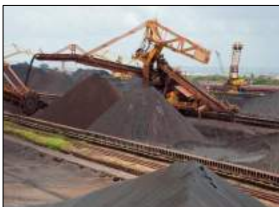
Foto 2.3: Minério de ferro sendo empilhado no pátio por empilhadeiras (modelo).
