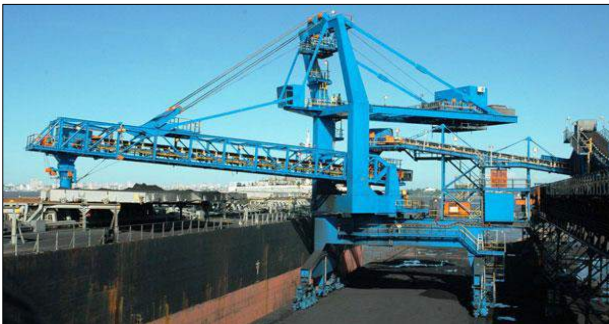
Foto 2.11: Carregador de navios tipo travelling para grãos (modelo).
