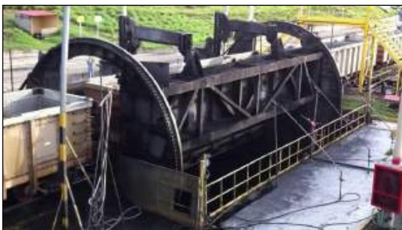
Foto 2.2: Virador de vagões Simples (modelo)
