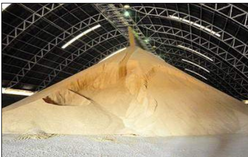
Foto 2.7: Empilhamento de grãos em armazém através de transportador de correia com tripper acoplado no teto (modelo).
