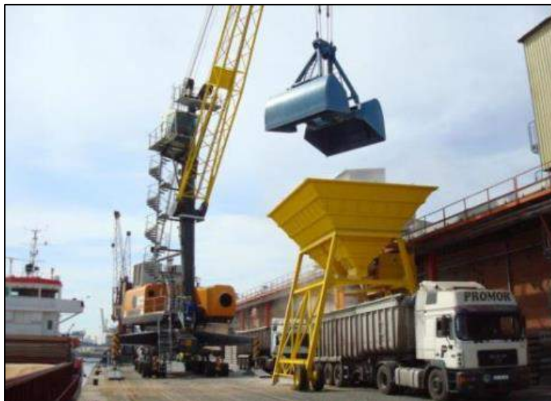
Foto 2.12: Carregamento de caminhões com o uso de guindaste MHC e moega de carregamento (modelo).
