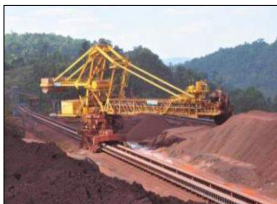
Foto 2.4: Recuperadora de minério de ferro do tipo lança e roda de caçamba (modelo)
