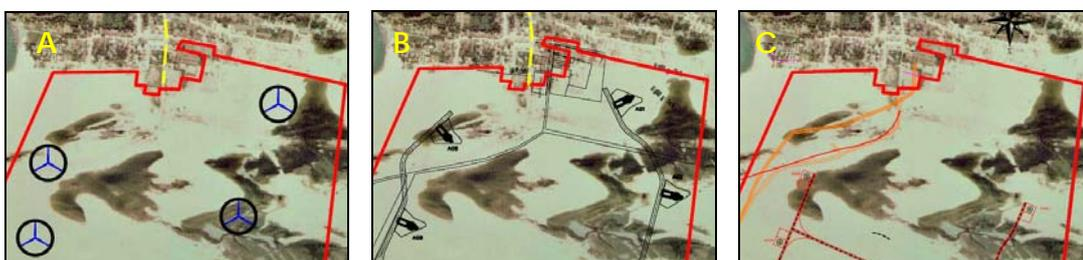
**Figura 2.4** - Principais alterações no lay-out dos aerogeradores para evitar áreas alagáveis no Parque Eólico Mundaú. A: Fase RAS; B: Aquisição do Projeto; C: Fase EIA/RIMA.
