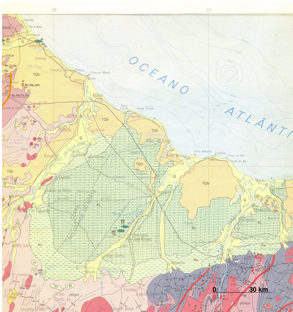
Figura 2: Mapa Geológico da Bacia Potiguar (Fonte: Campos et. al. 1979). Ka: Formação Açu, Kj: Formação Jandaíra, pE (gn): Embasamento cristalino, TQb: Grupo Barreiras indiviso Q: Aluviões. gip: lentes de gipsita.
