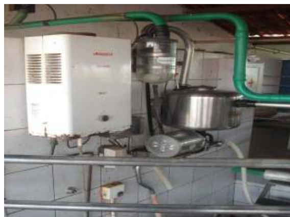
Foto 13 – Transferidor de Leite, onde após a ordenha o leite é encaminhado para a Sala do Leite.
